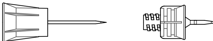
Рисунок 3 – Схематичное изображение иглы ВКД 15G×15 мм (LL), арт. НМТ.30.09.401 с канюлей
